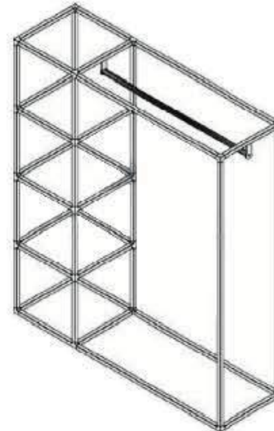
L-1 Yükseklik: 150 cm Genişlik : 130x39 cm Cam Ölçü: 34.7x89.7 cm / 1 adet 34.7x34.7 cm / 5 adet
